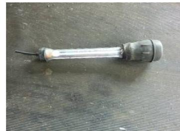
写真4 冷却水濃度測定器
