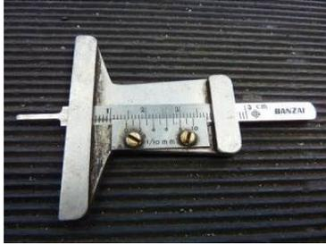
写真3 ティップスゲージによりタイヤの溝の深さを測ります。
