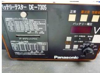
写真1 点検結果をプリントアウト(下記↓)できるバッテリーテスター
