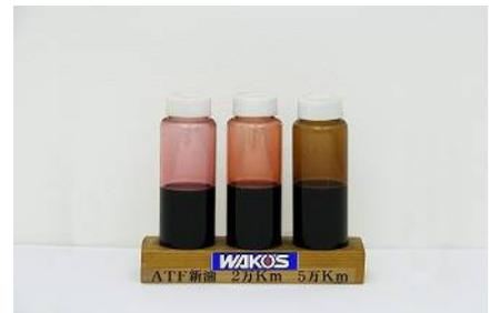
【汚れ比較管】ATFの走行距離による汚れ具合の比較
